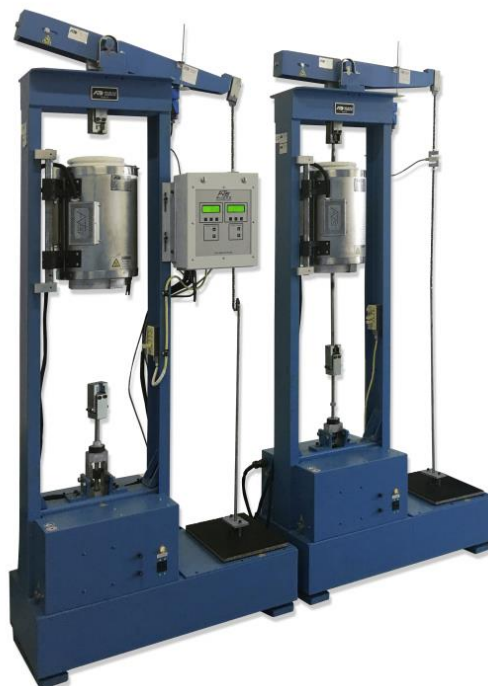
Рисунок 11 – Общий вид машины для испытаний на ползучесть, длительную прочность и релаксацию ATS серии 2000 модификаций 2350 ССМ и 2350 ССS
