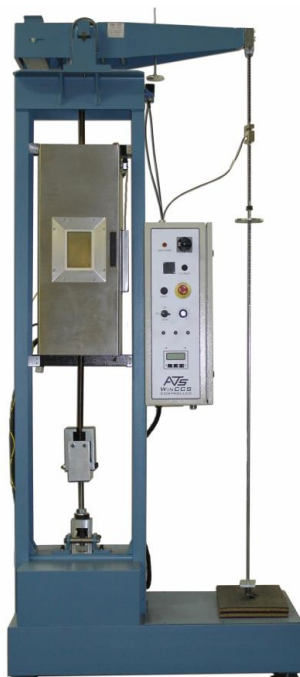
Рисунок 7 – Общий вид машины для испытаний на ползучесть, длительную прочность и релаксацию ATS серии 2000 модификации 2430 CCM
