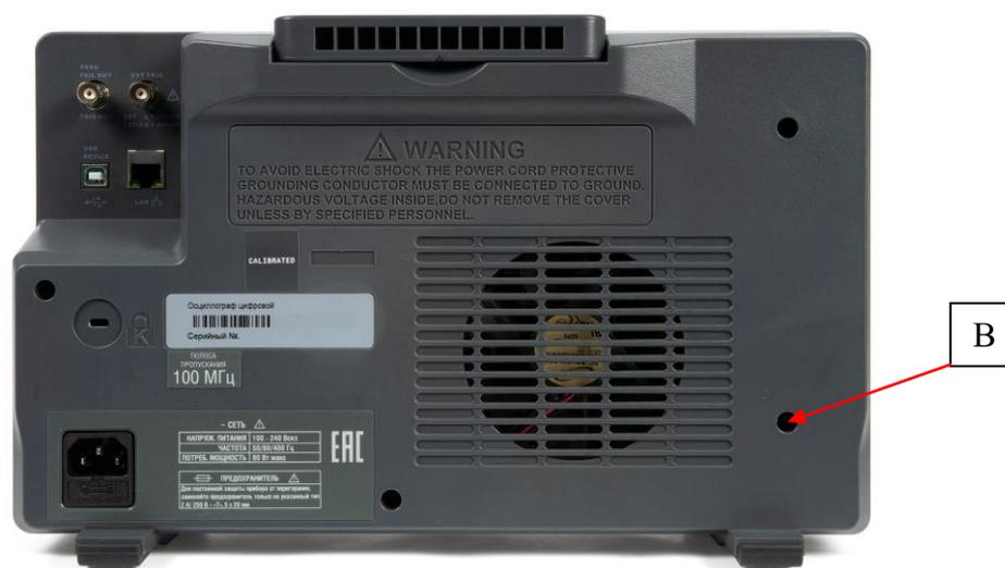
Рисунок 2 – Схема пломбировки от несанкционированного доступа (В)
