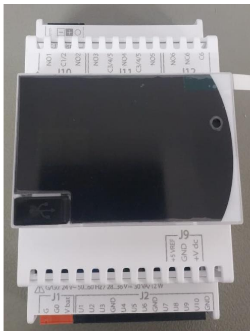
Рисунок 5 – Общий вид контроллеров логических программируемых с.pCO в корпусе с.pCO mini Basic моделей PR+DXXXXX0XLXX; PR+DXXXXXAXLXX; PR+DXXXXXCXLXX
