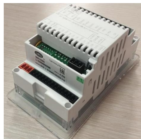
Рисунок 9 – Общий вид контроллеров логических программируемых с.рСО в корпусе с.рСО mini Basic моделей PR+PXXXXX0XEEX; PR+PXXXXAXEEX; PR+PXXXXCXEEX; PR+PXXXX0VBXX; PR+PXXXXAXBXX; PR+PXXXXCXBXX; PR+RXXXXX0XEEX; PR+RXXXXAXEEX; PR+RXXXXCXEEX; PR+RXXXX0VBXX; PR+RXXXXAXBXX; PR+RXXXXCXBXX
