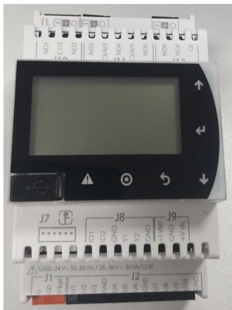
Рисунок 4 – Общий вид контроллеров логических программируемых с.pCO в корпусе с.pCO mini Enhanced моделей PR+DXXXXX1XEXX; PR+DXXXXXBXEXX; PR+DXXXXDXEXX; PR+DXXXXX1XBXX; PR+DXXXXBXBX; PR+DXXXXDXBXX
