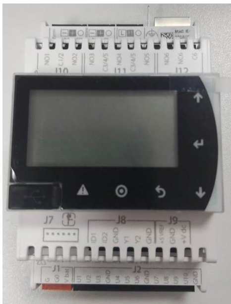
Рисунок 2 – Общий вид контроллеров логических программируемых с.pCO в корпусе с.pCO mini High-End моделей PR+DXXXXX1XEXX; PR+DXXXXXBXX; PR+DXXXXDXEXX; PR+DXXXXX1XBXX; PR+DXXXXBVBXX; PR+DXXXXDXBXX
