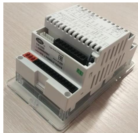
Рисунок 8 – Общий вид контроллеров логических программируемых с.рСО в корпусе с.рСО mini Enhanced моделей PR+PXXXXX1XEEX; PR+PXXXXXBXEEX; PR+PXXXXDXEEX; PR+PXXXX1XBXX; PR+PXXXXBVBXX; PR+PXXXXDXBXX; PR+RXXXXX1XEEX; PR+RXXXXBXEEX; PR+RXXXXDXEEX; PR+RXXXX1XBXX; PR+RXXXXBVBXX; PR+RXXXXDXBXX
