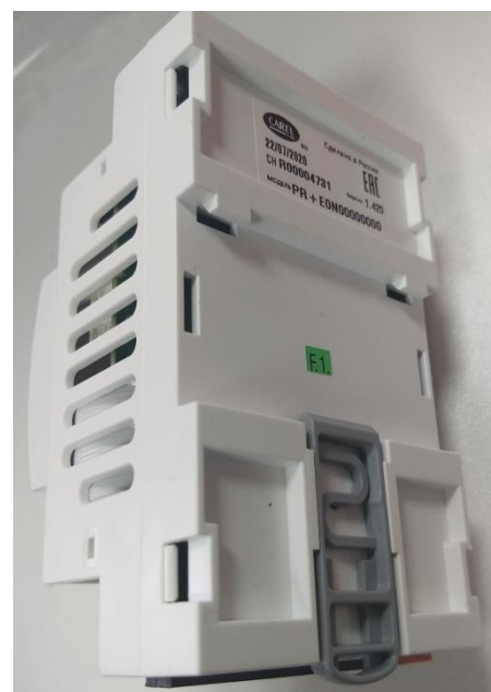
Рисунок 10 – Общий вид модуля расширения в корпусе с.pCOe моделей PR+E0XXXX0X0XX; PR+RXXXXX0X0XX
