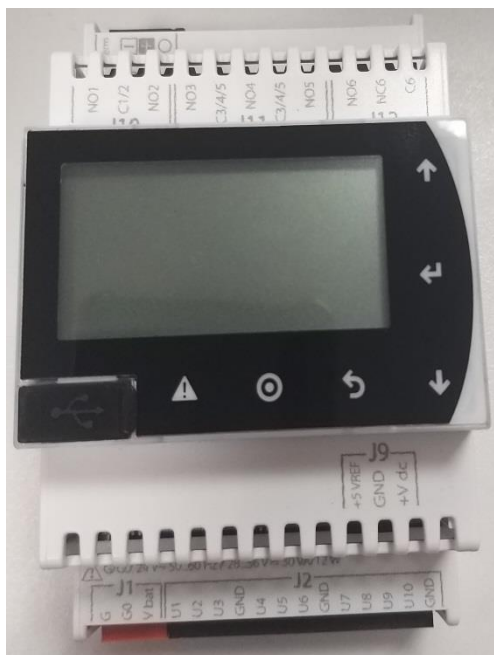
Рисунок 6 – Общий вид контроллеров логических программируемых с.pCO в корпусе с.pCO mini Basic моделей PR+DXXXXX0XEEXX; PR+DXXXXXAXEEXX; PR+DXXXXXCXEEXX; PR+DXXXXX0XBXX; PR+DXXXXXAXBXX; PR+DXXXXXCXBXX
