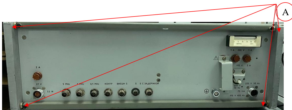
Рисунок 2 - Схема пломбировки от несанкционированного доступа (А)
