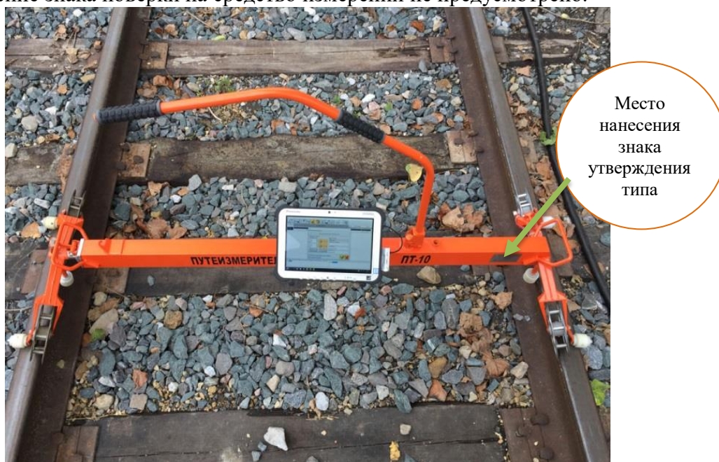
Рисунок 1 – Общий вид устройств для контроля рельсовой колеи (тележек путеизмерительных) ПТ-10
