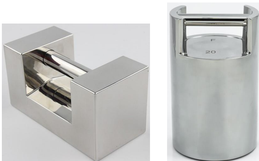
Рисунок 3 – Общий вид гирь из нержавеющей стали с номинальной массой от 5 кг до 20 кг цилиндрической формы с ручкой и параллелепипедной формы с ручкой
