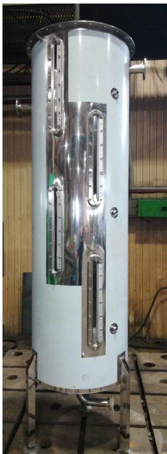
Рисунок 8 – Общий вид мерников МШ
