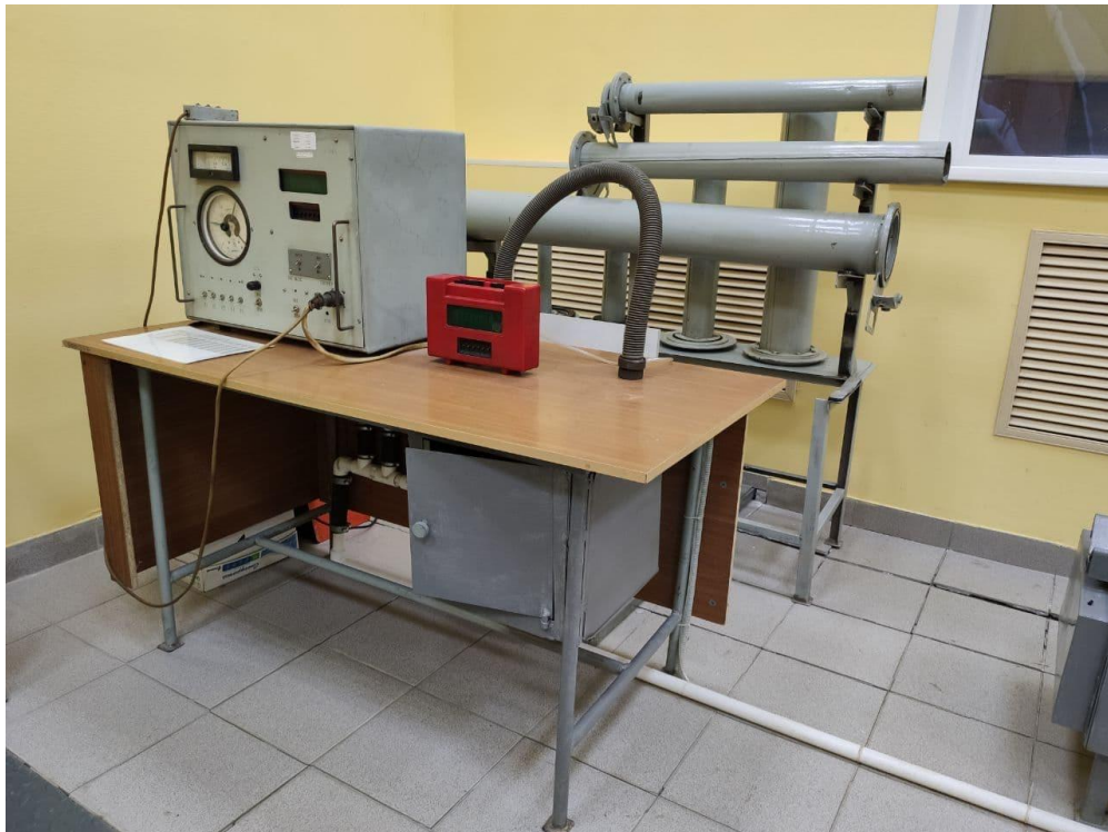
Рисунок 1 – Общий вид установки поверочной для счетчиков газа УПСГ-0,1/1000. Пульт управления и участок испытаний бытовых счетчиков
