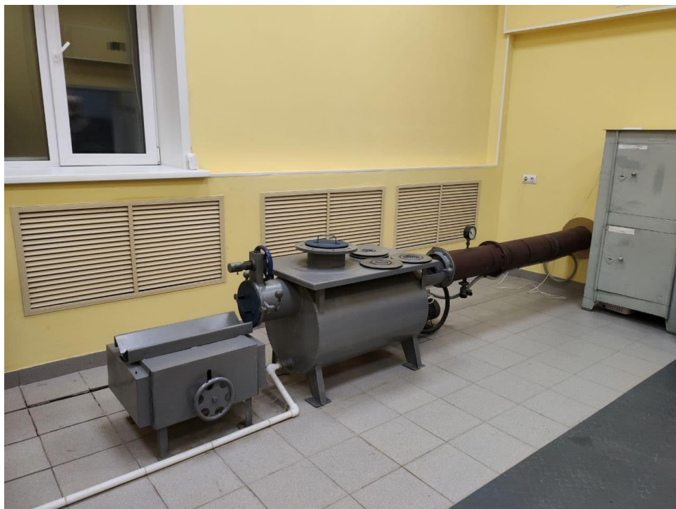
Рисунок 2 – Общий вид установки поверочной для счетчиков газа УПСГ-0,1/1000. Пульт управления и участок испытаний промышленных счетчиков
