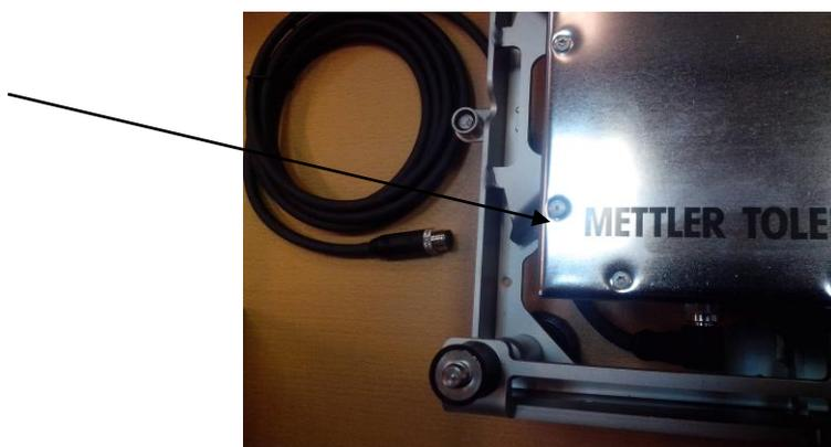
Рисунок 6 – Место установки "срывного" винта на крышке датчика
