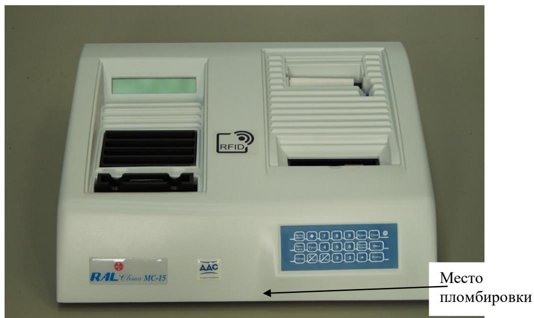
Рис. 1 Общий вид анализатора и схема пломбировки
