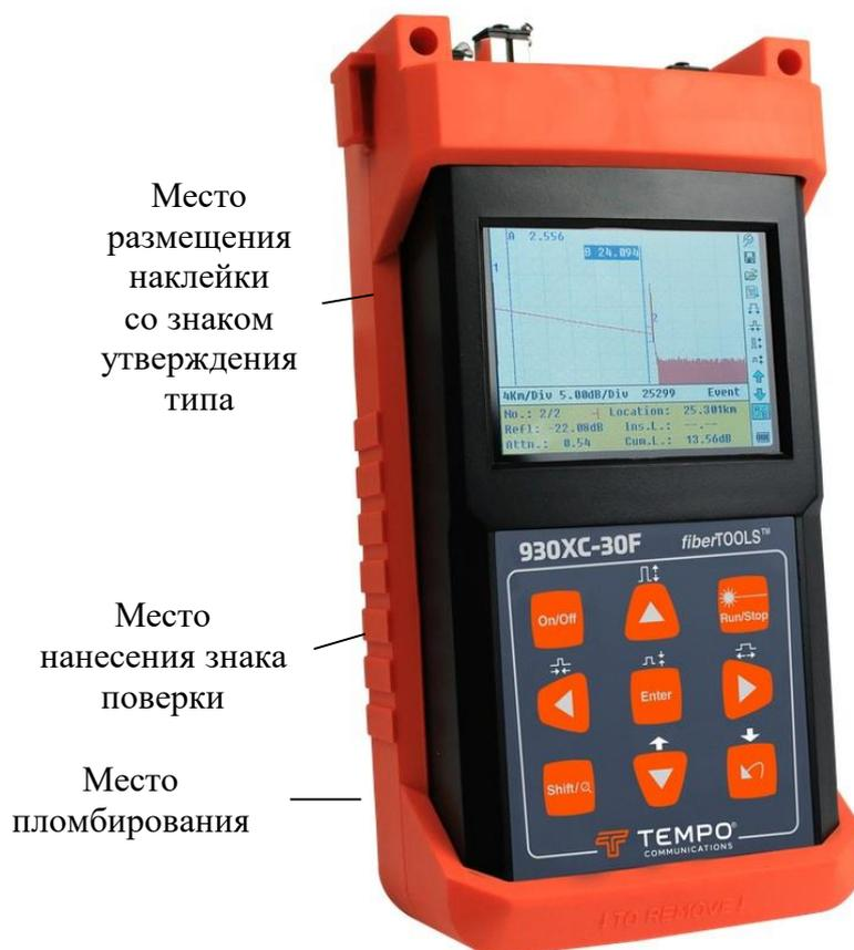
Рисунок 1 - Общий вид рефлектометра со схемой пломбировки от несанкционированного доступа и местом нанесения знака утверждения типа и знака поверки
