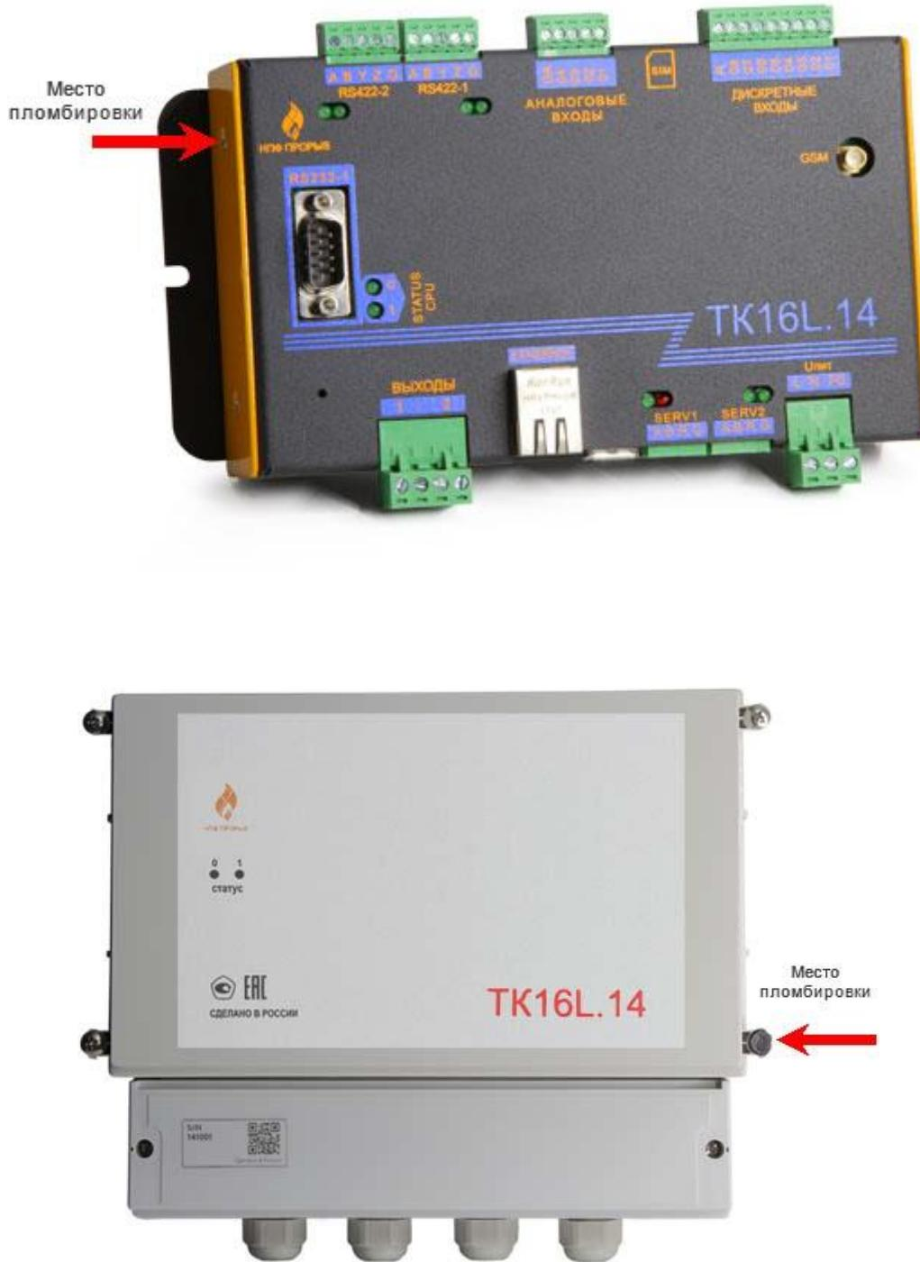
Рисунок 2 – Общий вид, места пломбирования УСПД с металлическим корпусом (вверху), с пластиковым корпусом (снизу)
