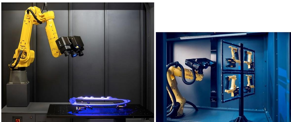
Рисунок 4 - Общий вид сенсоров систем ATOS 5 Airfoils (с фотограмметрической системой) и ATOS Q при размещении на роботе-манипуляторе в комплексе для автоматизированных измерений ScanBox
