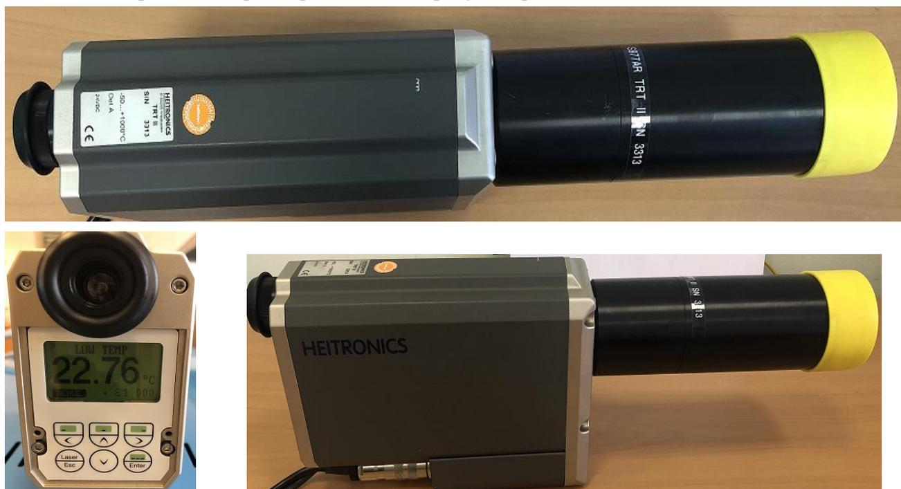
Рисунок 1 – Общий вид пирометра
