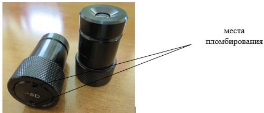
Рисунок 2 – Общий вид оптической меры, ее маркировка и схема пломбирования.
