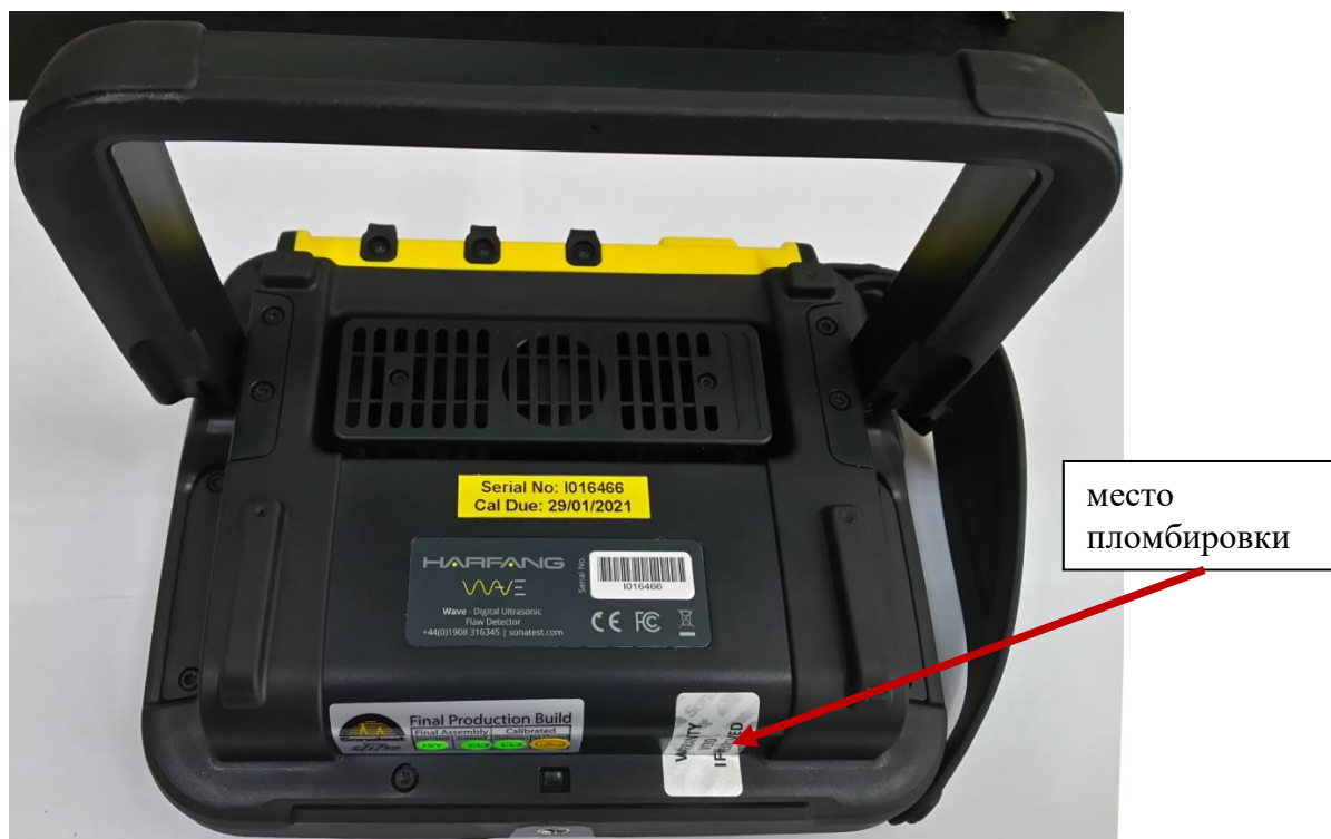
Рисунок 2 – Схема пломбировки от несанкционированного доступа
