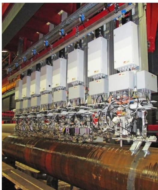
Рисунок 1 – Общий вид компоновки установок ультразвукового контроля автоматизированных ULTRAPIPE
