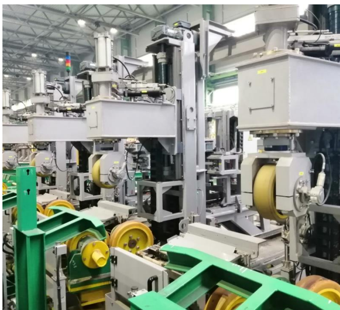
Рисунок 1 – Общий вид компоновки установок ультразвукового контроля автоматизированных ULTRAPIPE
