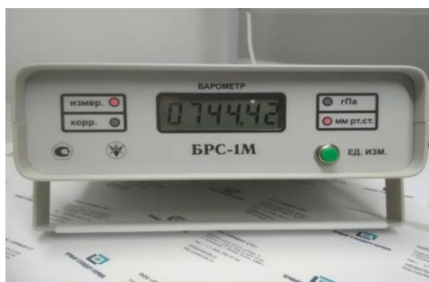
Рисунок 4 Барометр рабочий сетевой BPC-1M. Вид общий
