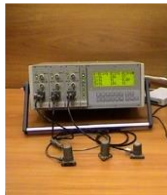
Рисунок 13 – Блок электронный БЭ-40-4М из состава аппаратуры измерений роторных вибраций ИВ-Д-СФ-3М Вид общий
