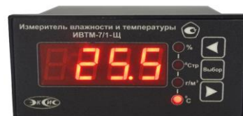
Рисунок 15 – Измеритель влажности и температуры ИВТМ-7 М К. Вид общий
