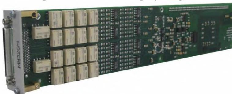
Рисунок 1 – Общий вид измерителей мгновенных значений напряжения МН32СМ
