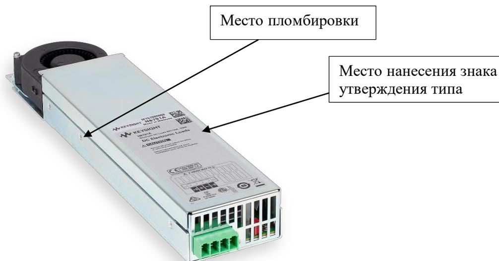
а) Общий вид нагрузок электронных модульных N6791A
