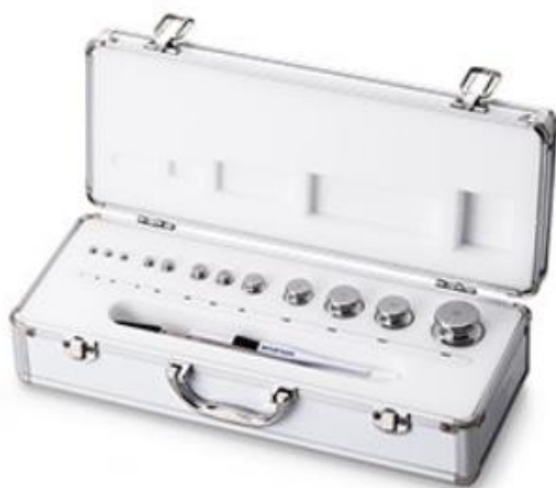
Рисунок 5 – Общий вид набора из 25 гирь (E1, E2, F1, F2, M1) с номинальными значениями массы от 1 мг до 1 кг
