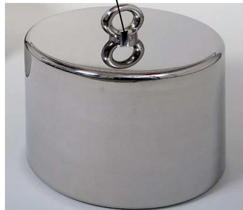
Рисунок 11 – Общий вид гирь (F1, F2) цилиндрической формы с кольцом для захвата и пример схемы пломбирования
