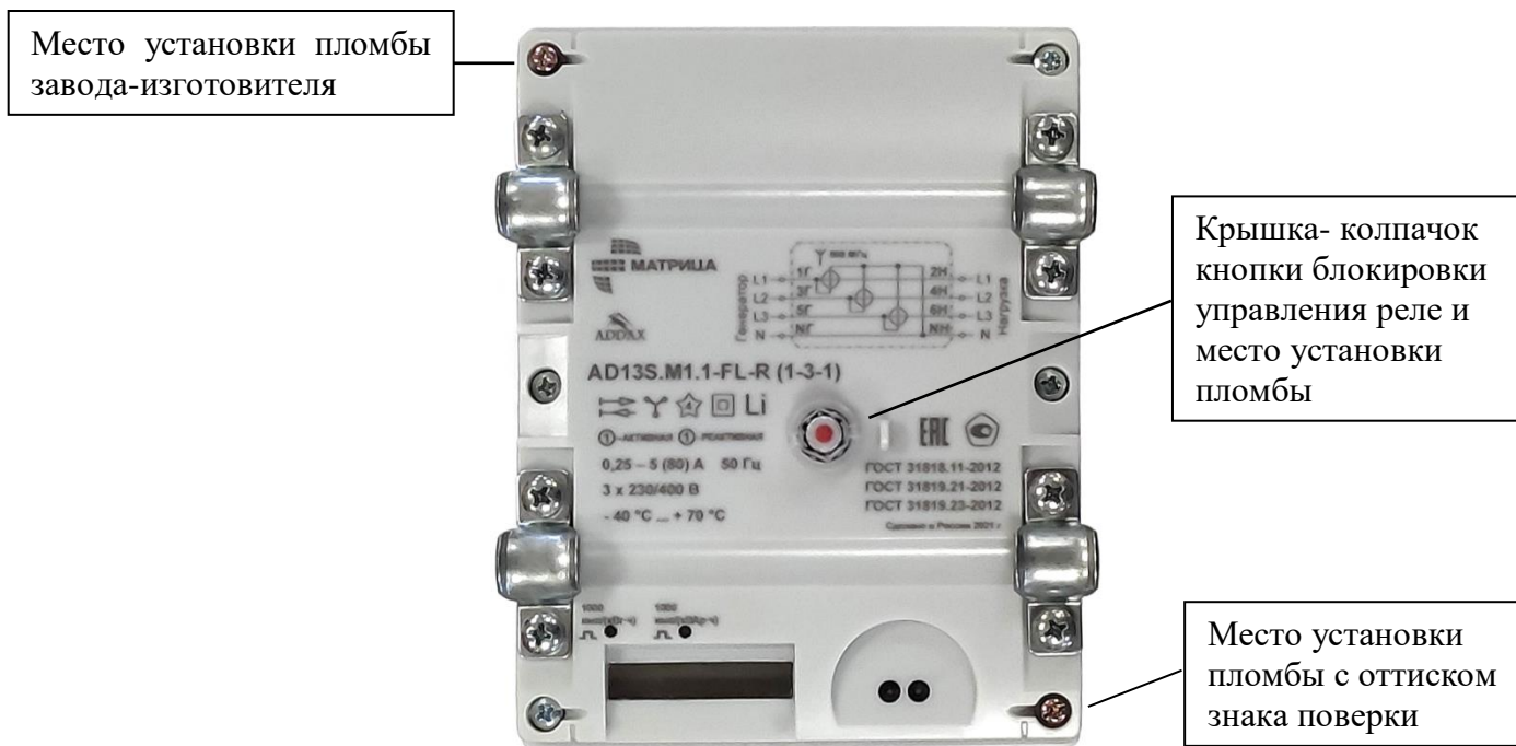
Рисунок 2 – Общий вид счетчика в корпусе AD13S.M1 и схема его пломбировки
