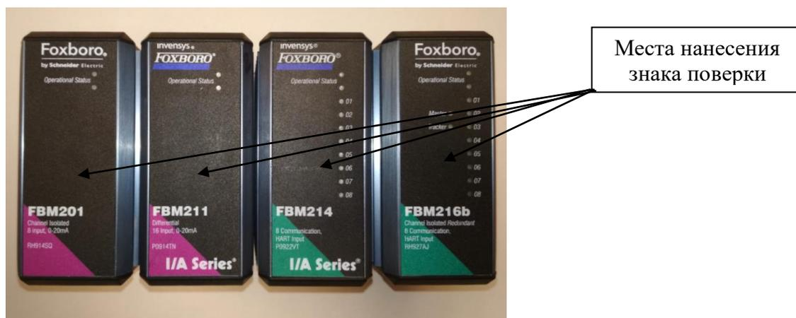
Рисунок 1 - Модули Fieldbus (FBM), монтируемые на DIN - рейку
