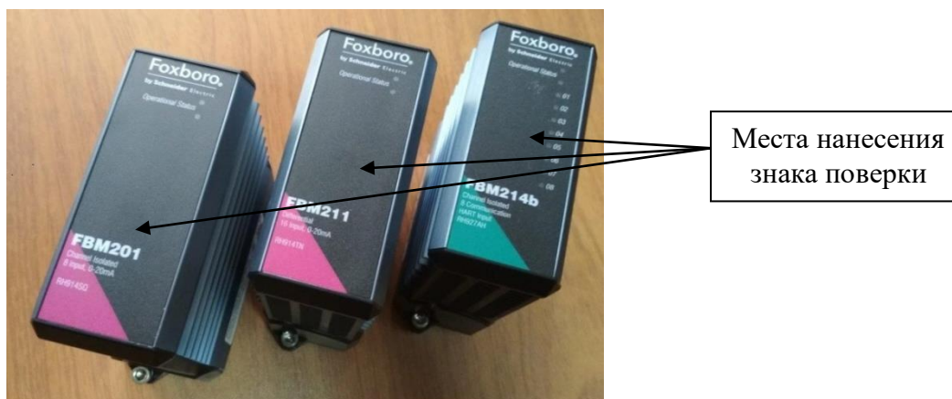
Рисунок 1 - Модули Fieldbus (FBM), монтируемые на DIN - рейку
