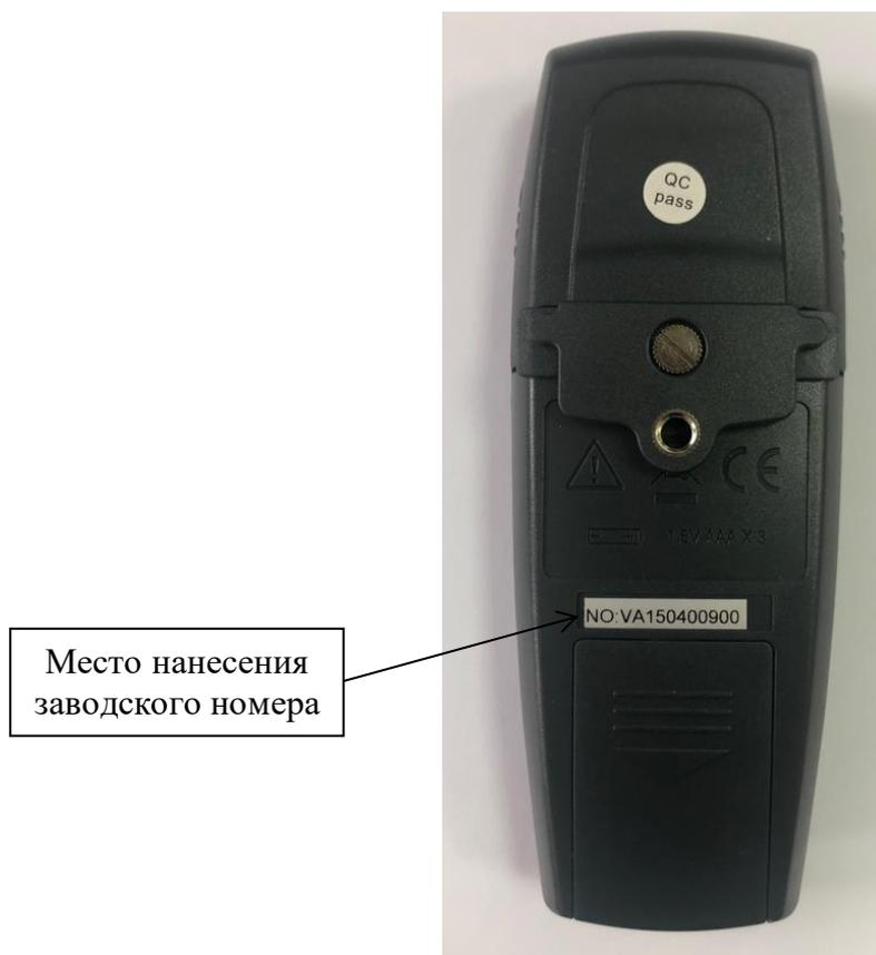
Рисунок 5 – Место нанесения заводского номера анемометра крыльчатого VA
