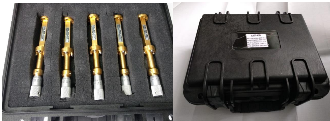
Рисунок 7 – Общий вид комплекта МП-06 (НРП-28, НРП-29, НРП-27, НСП-23, НКП-22, НРП-27, НРП-24)
