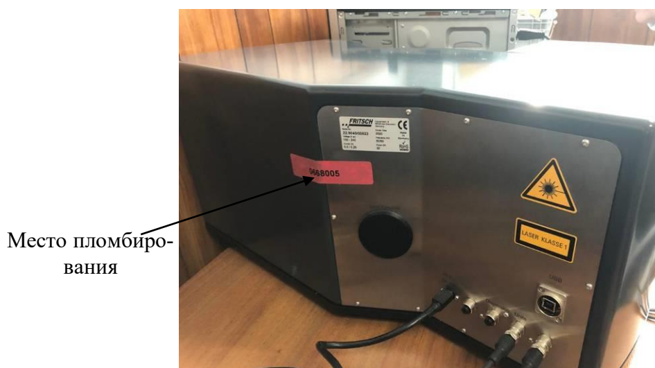
Рисунок 2 – Схема пломбировки анализаторов от несанкционированного доступа
