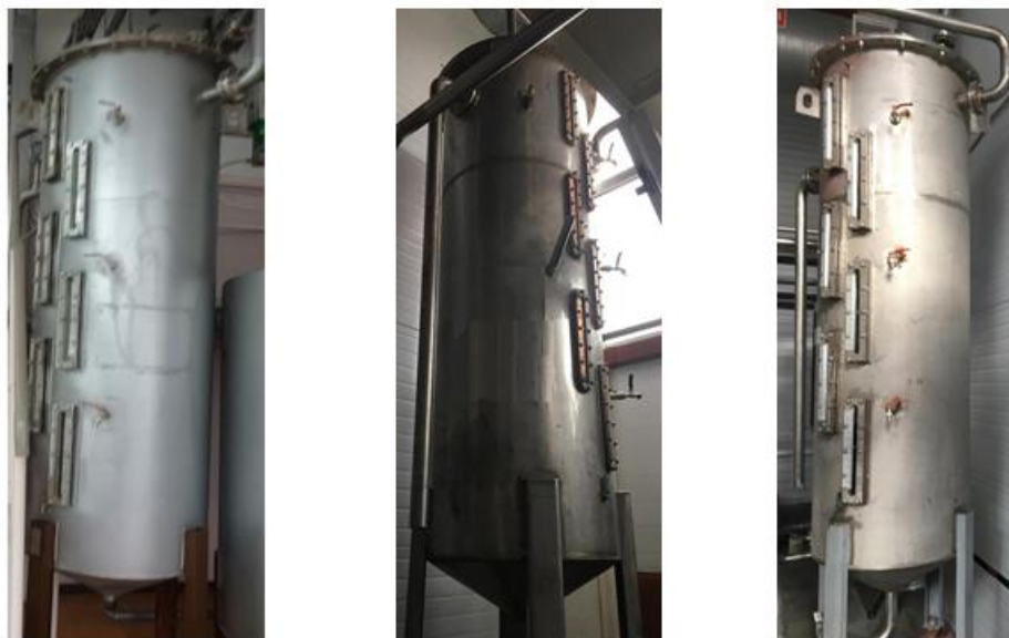
Рисунок 1 - Общий вид мерников МТ-ВИЦ-75Н, зав.№№ 18-83, 18-85, 18-86
