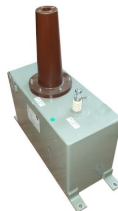
Рисунок 4 – Общий вид опорной емкости из блока СНЧ
