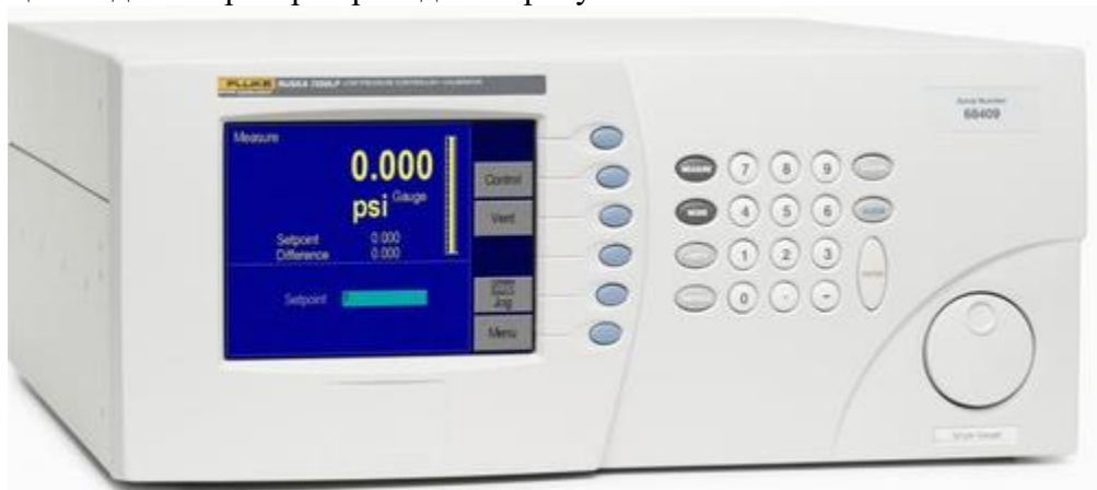
Рисунок 1 – Общий вид калибратора давления Ruska 7250LP
