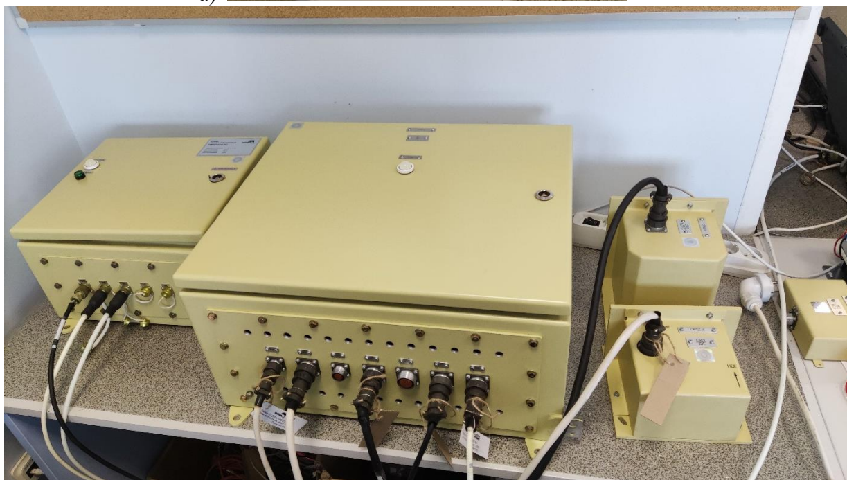
Рисунок 1 – Общий вид системы регистрации параметров движения «СРПД-К» а) мобильное средство вычислительной техники; б) блок преобразователей, блок акселерометров, блок датчиков угловых скоростей, шкаф коммуникационный.
