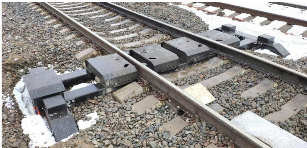
Рисунок 1 – Общий вид комплексов цифровых диагностических для измерений геометрических параметров колесных пар подвижного состава «Комплекс-2 КОНЛОК»
