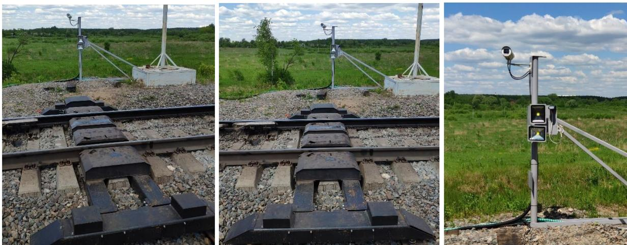
Рисунок 3 – Общий вид комплексов цифровых диагностических для измерений геометрических параметров колесных пар подвижного состава «Комплекс-2 КОНЛОК», оснащенных системой распознавания номеров вагонов
