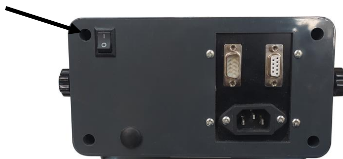
Рисунок 3 – Схема пломбировки от несанкционированного доступа и обозначение места для нанесения отпечатка клейма
