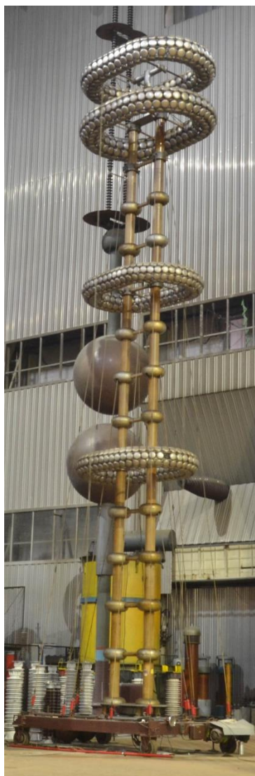
Рисунок 1 - Общий вид делителя напряжения универсального УДН-4
