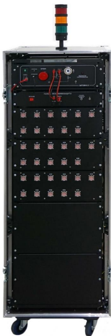
Рисунок 1 – Общий вид устройств контроля монтажа БИВК-МН
