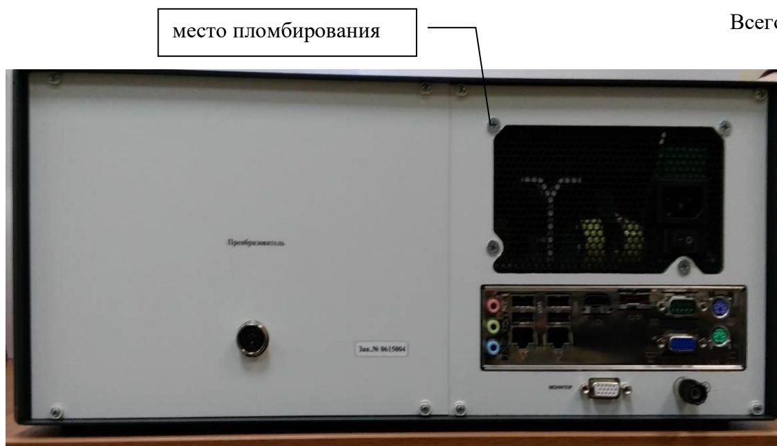
Рисунок 3 – Схема пломбирования БИ. Задняя панель
