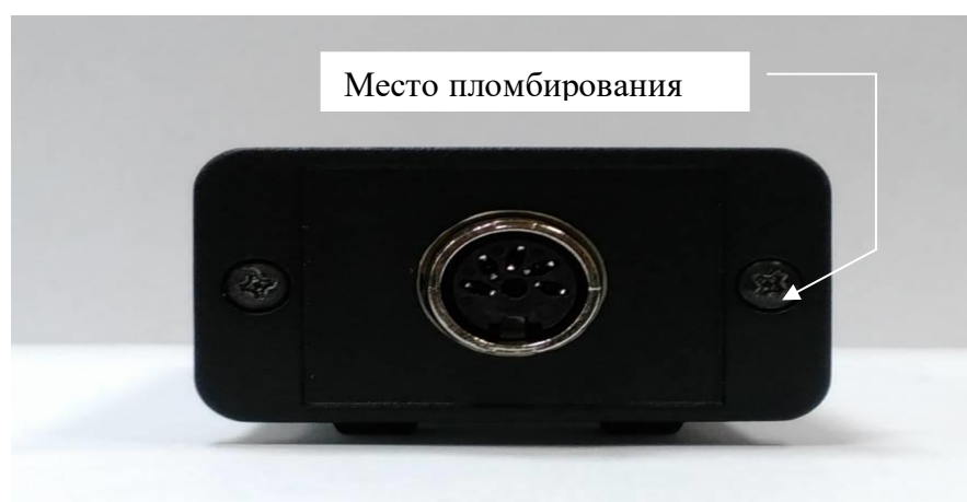
Рисунок 5 – Схема пломбирования ПВ
