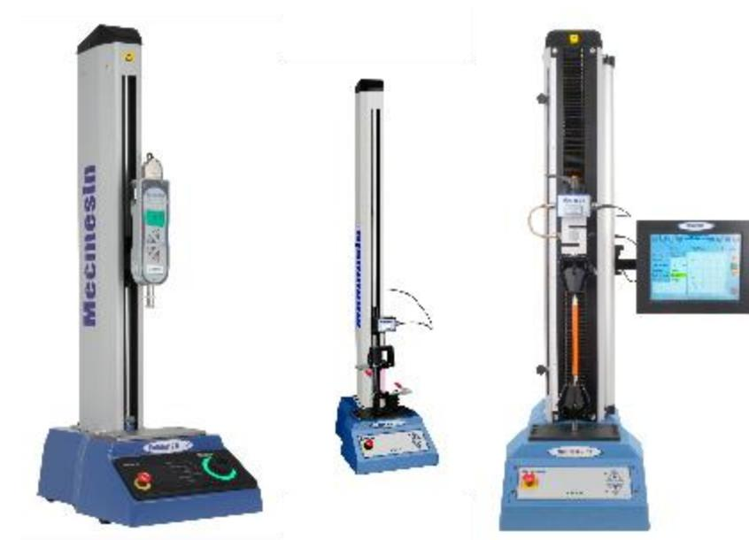
Рисунок 1 – Общий вид машин MultiTest в одноколонном исполнении
