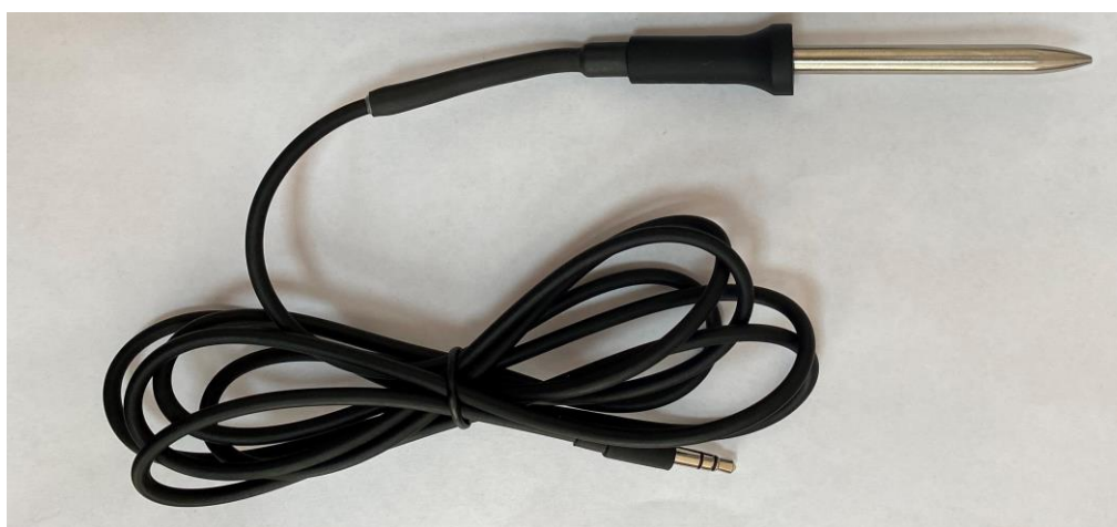
Рисунок 2 – Общий вид температурного зонда PR3
