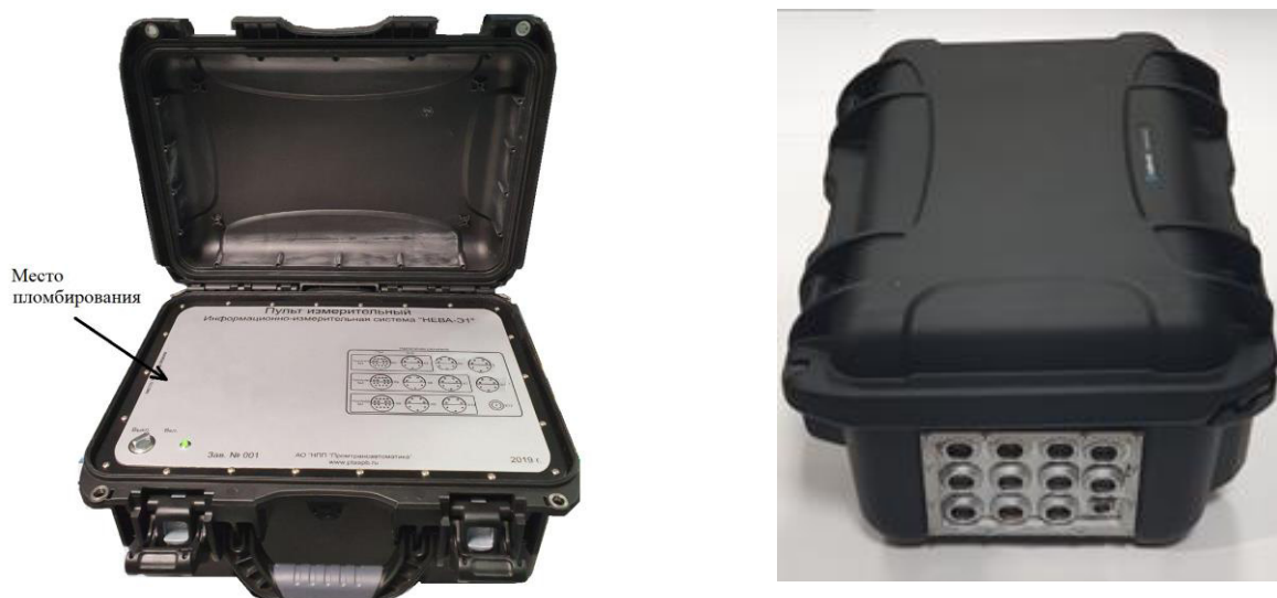
Рисунок 1 – Общий вид надводной части системы с указанием места пломбирования
