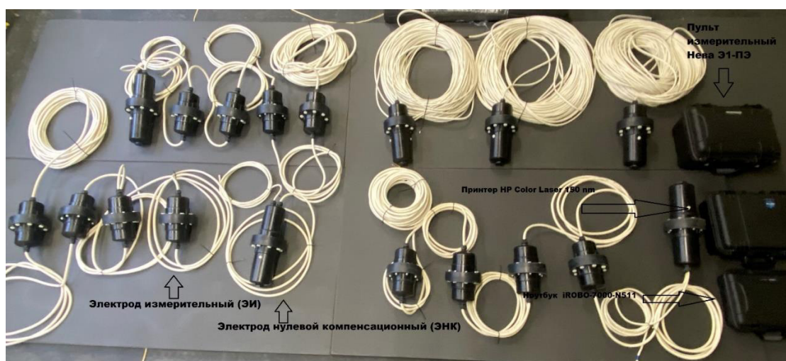
Рисунок 3 – Общий вид системы вместе с подводной частью
