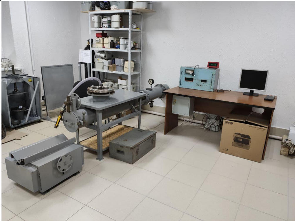
Рисунок 1 – Общий вид установки поверочной для счетчиков газа УПСГ-1000
