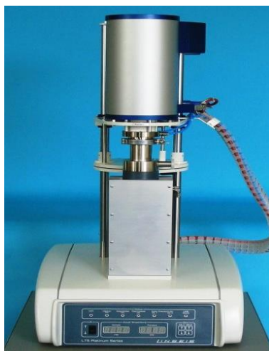
Рисунок 2 – Общий вид измерительного блока dilatометра с толкателем L – series модификации L75V
