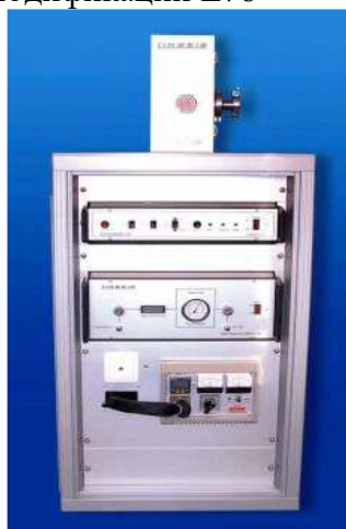
Рисунок 4 – Общий вид измерительного блока dilatометра с толкателем L – series модификации L78/RITA
