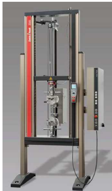
Рисунок 4 - Общий вид машин универсальных испытательных Z005, Z010, Z020, Z030, Z050, Z100, Z150
