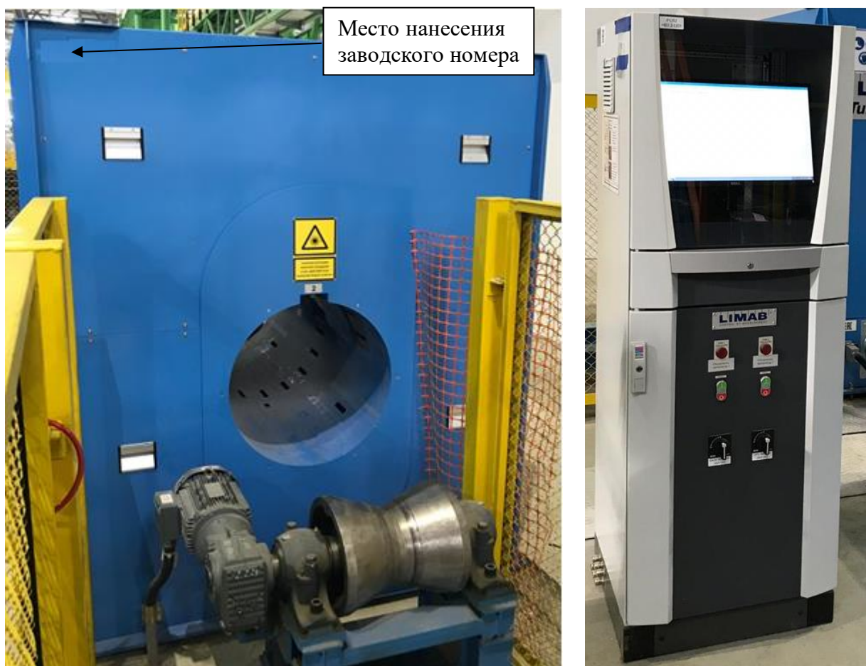
Рисунок 1 - Общий вид системы автоматизированного измерения концевых участков труб TubeProfiler S с указанием места нанесения заводского номера
