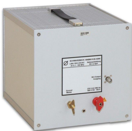
Рисунок 1г - Эквивалент сети NNBM 8126 A 890 (слева), NNBM 8124-800 (справа)
