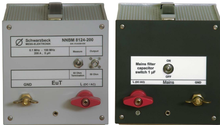
Рисунок 1б - Эквивалент сети NNBM 8124-200 вид спереди (слева), NNBM 8124-200 вид сзади (справа)
