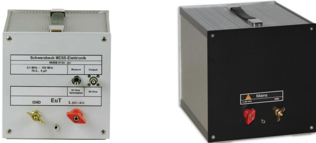
Рисунок 1а - Эквивалент сети NNBM 8124 вид спереди (слева), NNBM 8124 вид сзади (справа)
