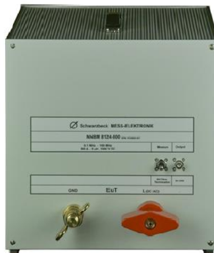
Рисунок 1г - Эквивалент сети NNBM 8126 A 890 (слева), NNBM 8124-800 (справа)
