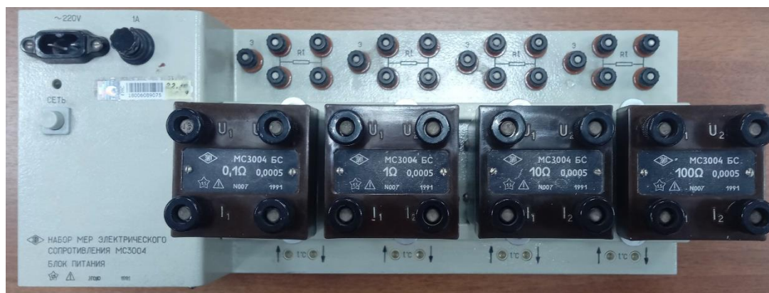
Рисунок № 1 - Общий вид набора мер электрического сопротивления МС3004
