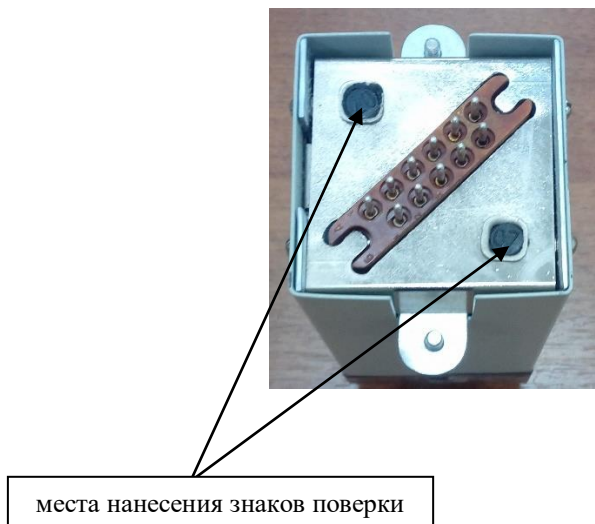
Рисунок 5 – Схема пломбировки от несанкционированного доступа и обозначение мест нанесения знаков поверки
