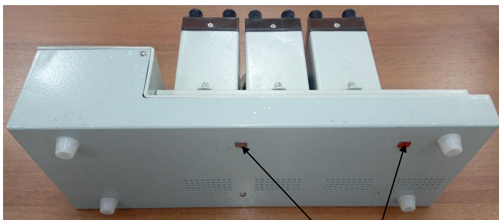
Рисунок 3 – Схема пломбировки от несанкционированного доступа и обозначение мест нанесения знаков поверки
