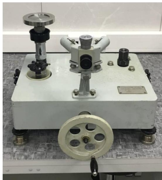
Рисунок 2 – Общий вид рабочего эталона единицы давления РЭД, автономный измерительный блок № 19
