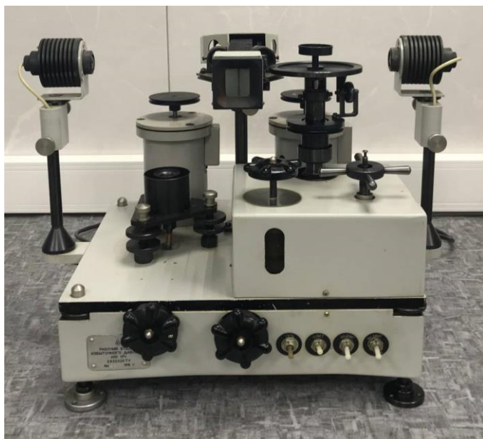
Рисунок 1 – Общий вид рабочего эталона единицы давления РЭД, автономный измерительный блок № 22
