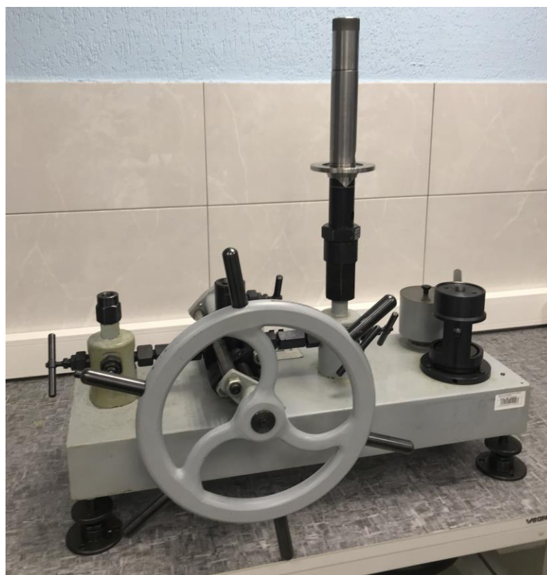
Рисунок 3 – Общий вид рабочего эталона единицы давления РЭД, автономный измерительный блок № 1026
