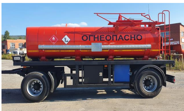
Рисунок 1 – Общий вид ПЦ с одной секцией
