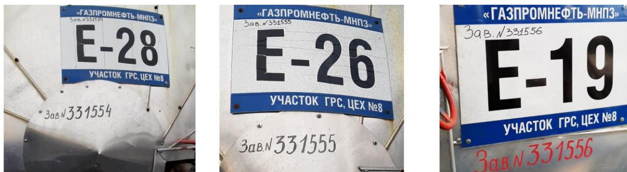
Рисунок 2 – Место нанесения заводских номеров
