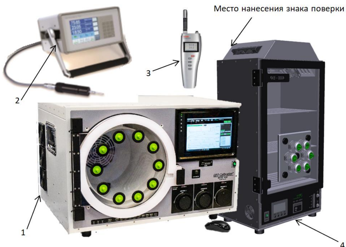
Рисунок 1 - Внешний вид и обозначение места нанесения знака поверки 1 – генератор влажного газа MODEL 4000SP, 2 – гигрометр 473- RP2/GEO Dew Point Mirror, 3 – гигрометр Rotronic модификации HygroPalm исполнения HP23-A, 4 – камера влаги MODEL 4000EXP.
