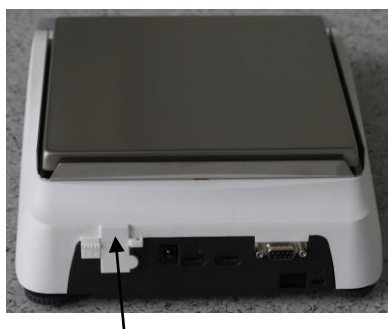
Рисунок 10 – Место пломбирования весов от несанкционированного доступа
